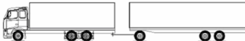
MVT type 4, lastbil-påhængsvogn, som medfører større vogntogslængde end 18,75 m (akselkonfiguration kan være anderledes)
